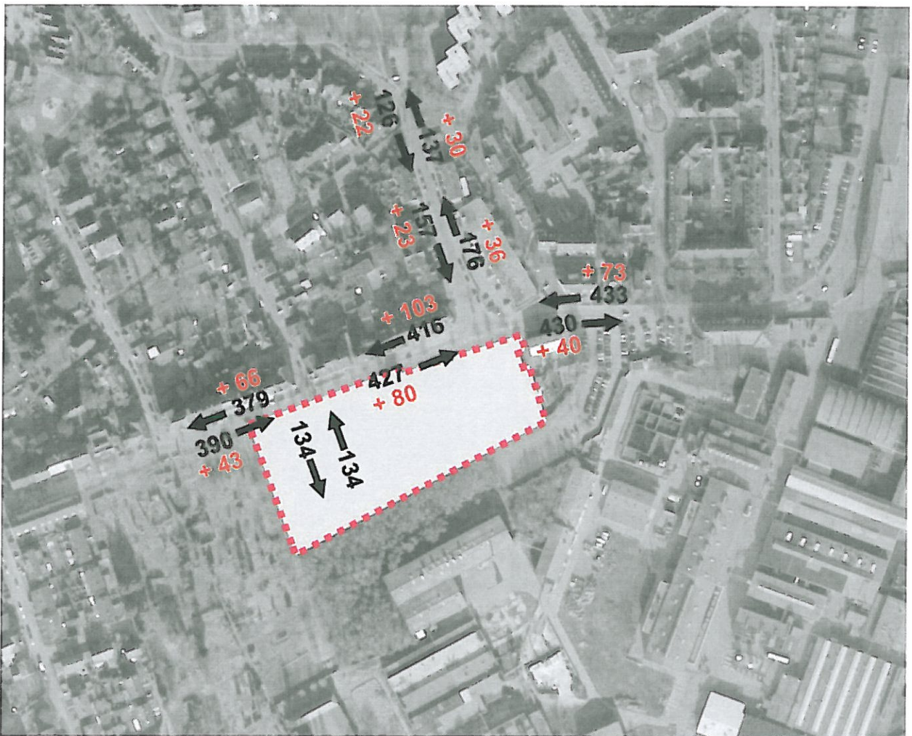
Abbildung 8: Prognosebelastung 2015 in der nachmittäglichen Spitzenstunde (schwarz - absolute Belastung, rot – Zunahme gegenüber heute)
