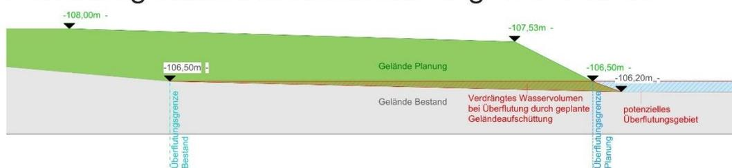
Die Breite des in den Querprofilen dargestellten Fließquerschnittes bis zur Höhenkote von 106,50 mNHN beträgt ca. 880 m. Der breiteste Bereich, der durch die Auffüllungen verloren geht, beträgt ca. 25 m.
