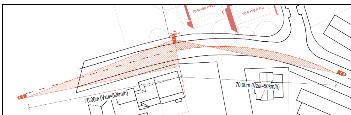
Abb. 5: Sichtprüfung Zu- und Abfahrt Tiefgarage am Holzener Weg (abvi 2024)
