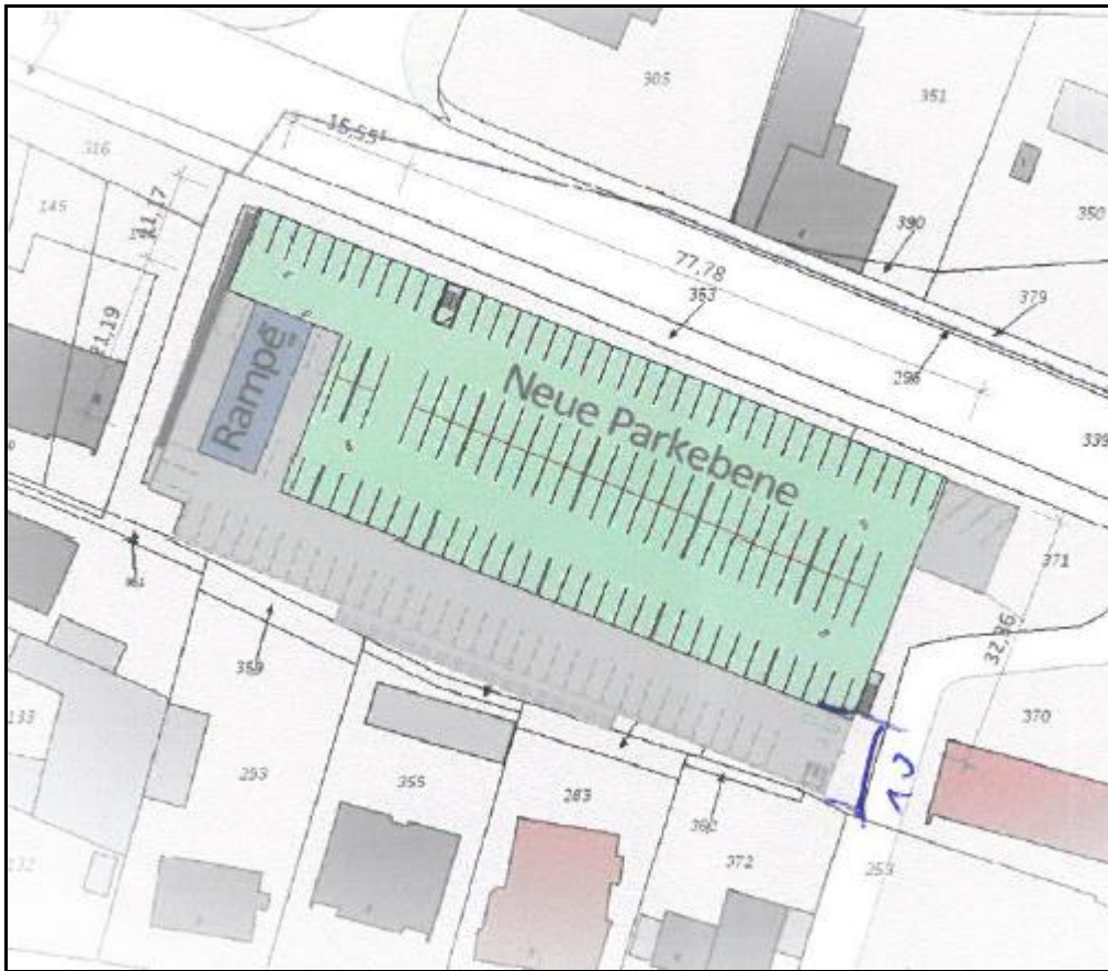
Abbildung 7: Lageplan (o.M.) der geplanten Aufstockung des Parkdecks um eine Ebene, Ingenieurbüro Schülke Wiesmann, Stand: 14.07.2017
