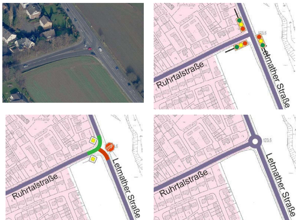
Abb. 58 Heutige Situation und mögliche alternative Regelungen bzw. Umgestaltungen am Knotenpunkt Letmather Straße (B 236)/Ruhrtalstraße (L 675)
